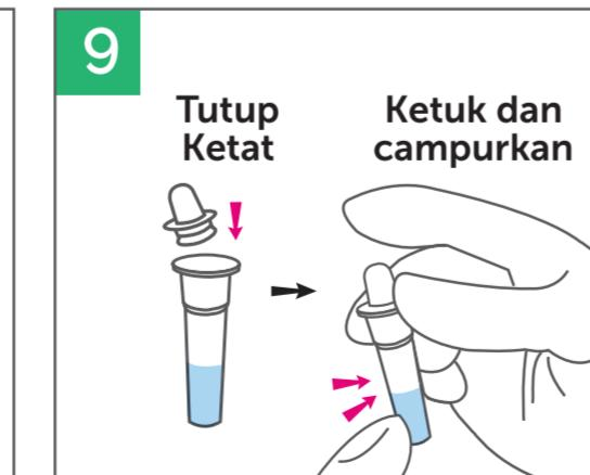
Tutup tiub penutup penitis dengan ketat, ketuk tiub dan campurkan larutan sampel secara menyeluruh.
