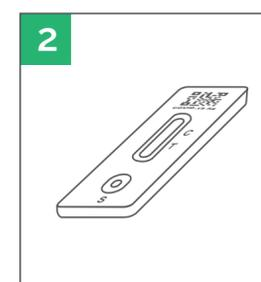
将检测卡放在干净，平整的表面上。为检测卡标上样本的名称。
